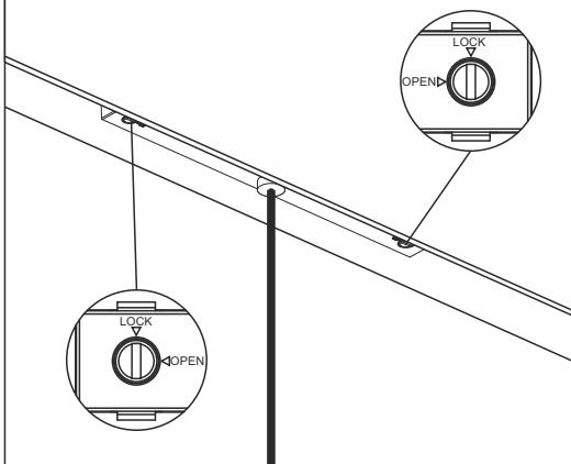
**4** Для регулировки высоты ослабьте фиксирующий винт на корпусе светильника.
