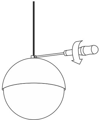
**5** Отрегулируйте высоту светильника [1], затяните фиксирующий винт [2].
