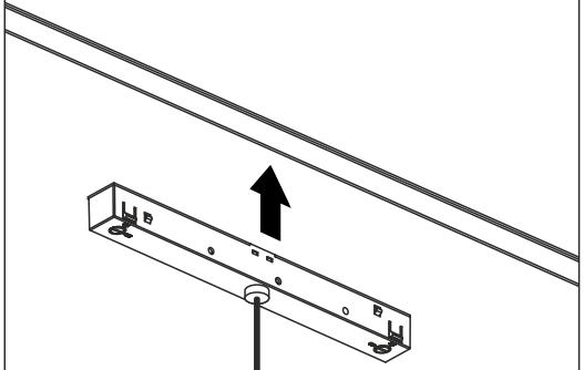
**!** Установка светильника осуществляется при выключеной электрической сети.
